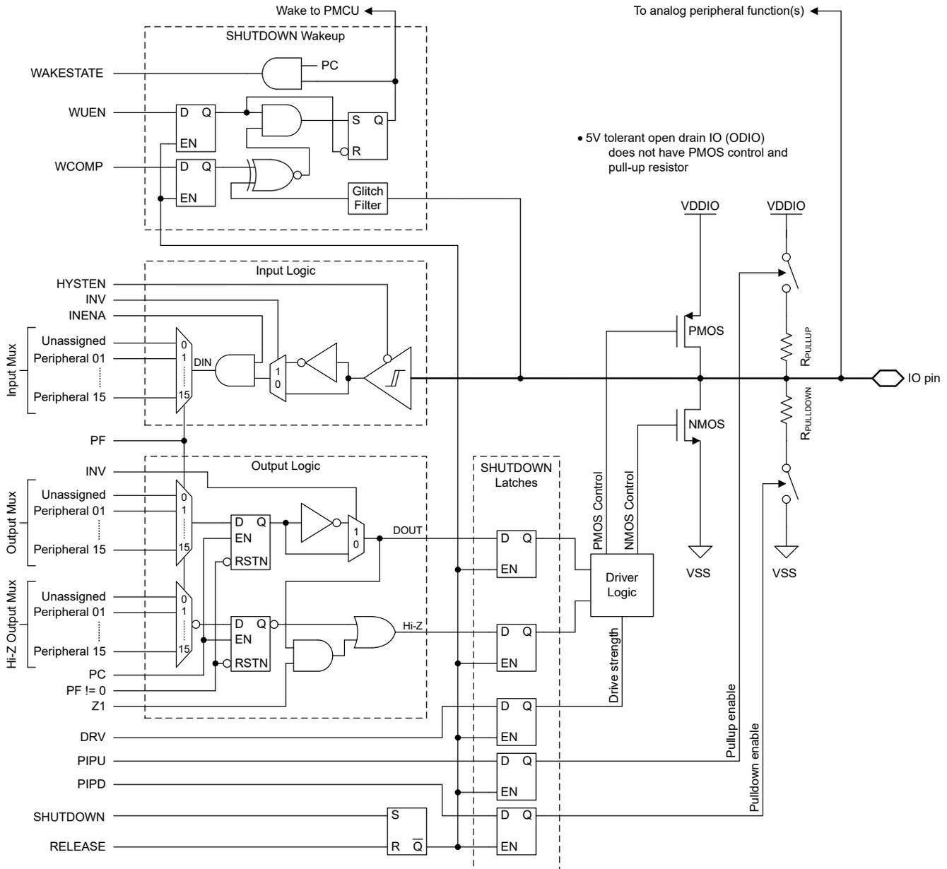
図 8-2. 入力 / 出力の回路図 (上位セット)
