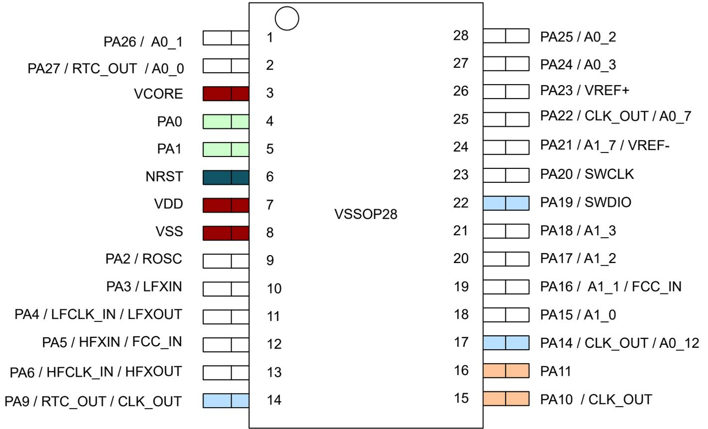
図 6-6. 28 ピン DGS28 (VSSOP) (上面図)
