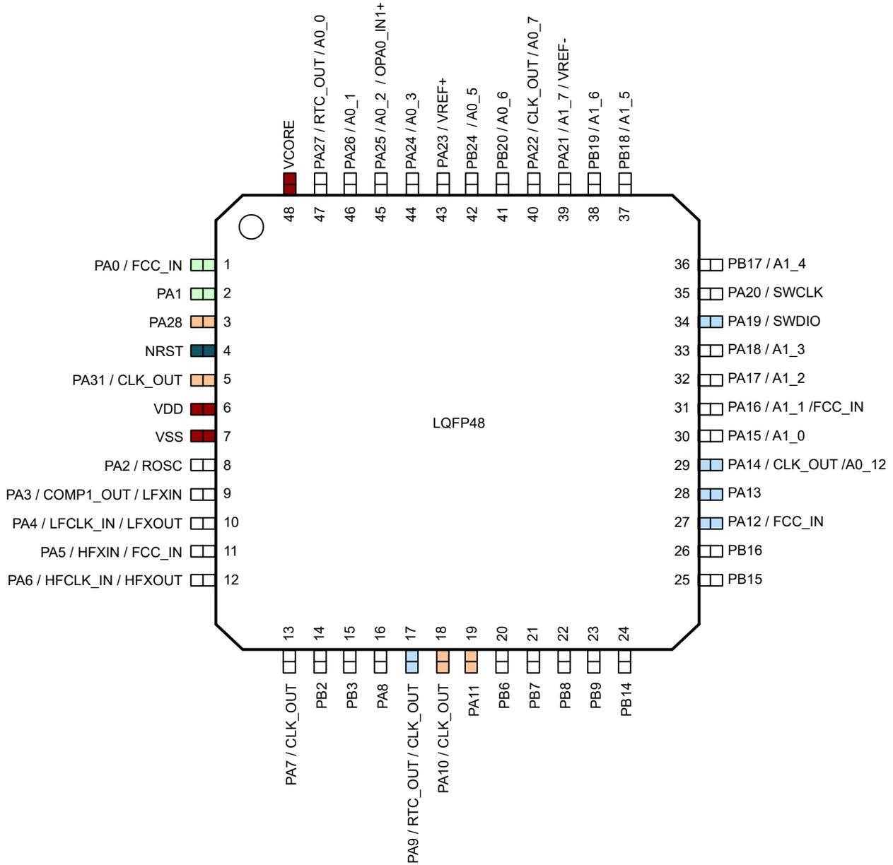
図 6-3. 48 ピン PT (LQFP) (上面図)
