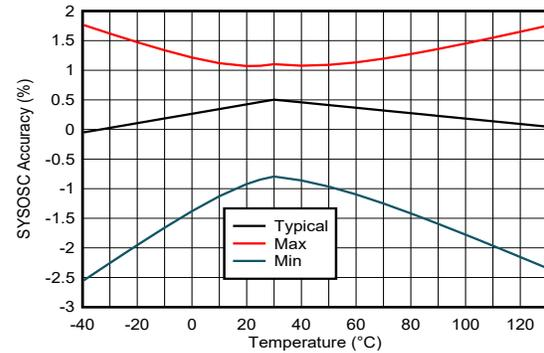
図 7-2. FCL が ON のときの SYSOSC 精度 (32MHz)
