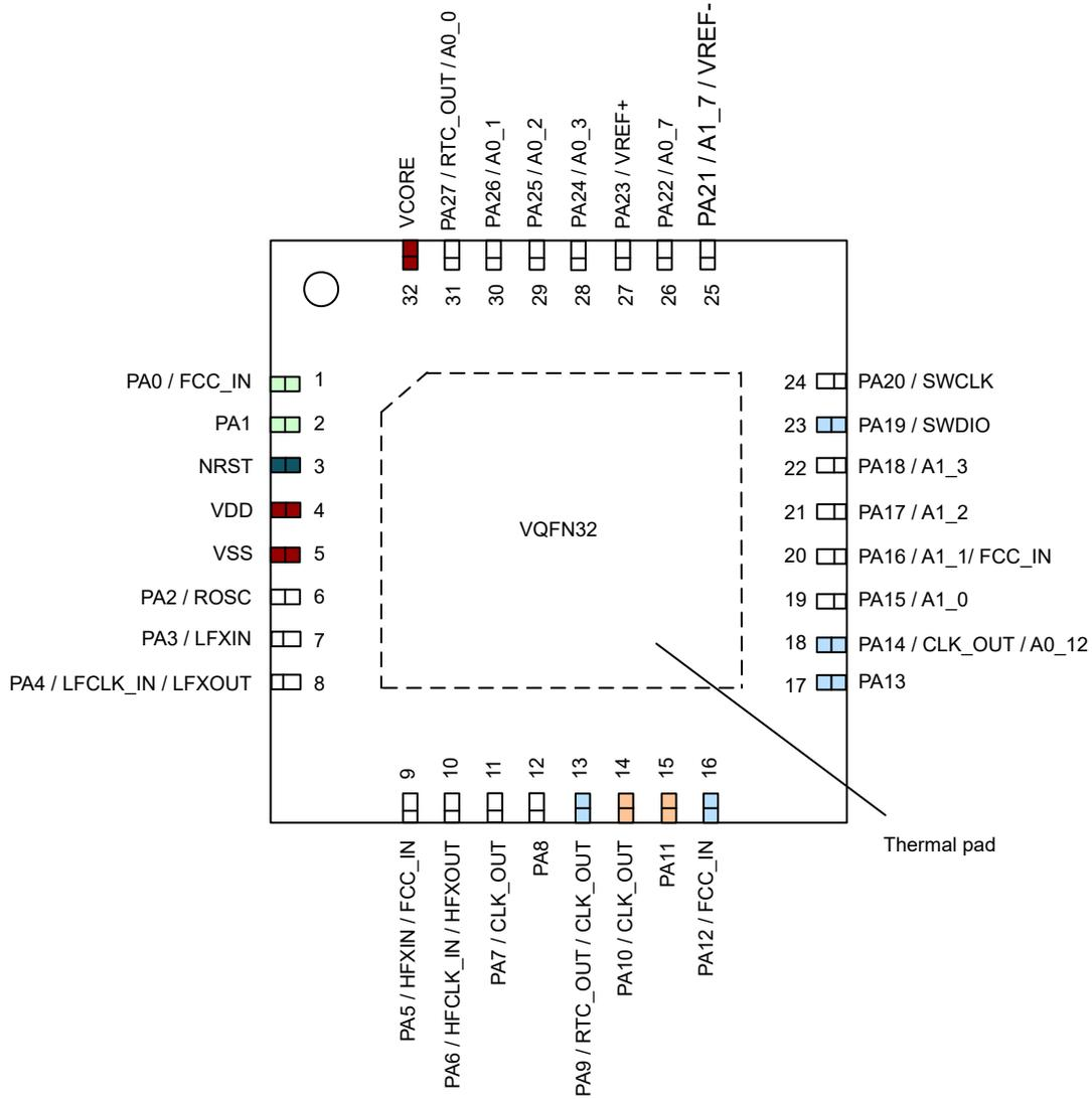
図 6-5. 32ピン RHB (VQFN) (上面図)
