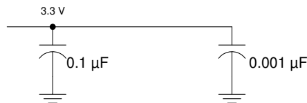
図 9-2. 推奨される LVDS バイパス コンデンサのレイアウト
