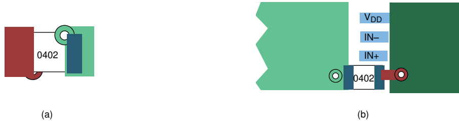
図 11-7. デカップリング コンデンサの標準レイアウト
