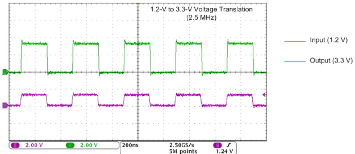
図 9-2. 2.5MHz での昇圧変換 (1.2V→3.3V)
