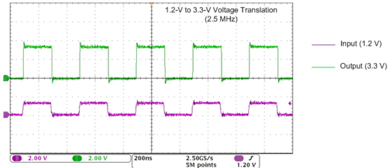
図 9-4. 2.5MHz での昇圧変換 (1.2V→3.3V)
