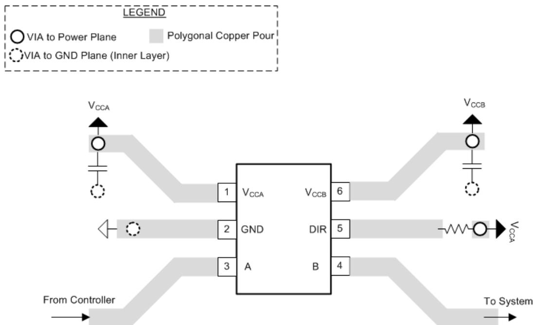
図 11-1. PCB のレイアウト例
