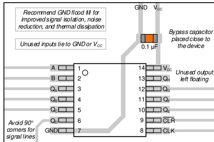
図 8-3. TSSOP の SN74LV8T164 のレイアウト例
