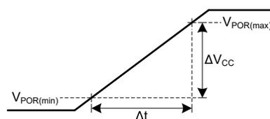
図 7-1. 既知のパワーアップ状態での電源 (V<sub>CC</sub>) ランプ特性
