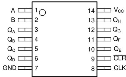
図 4-1. PW パッケージ、14 ピン TSSOP (上面図)
