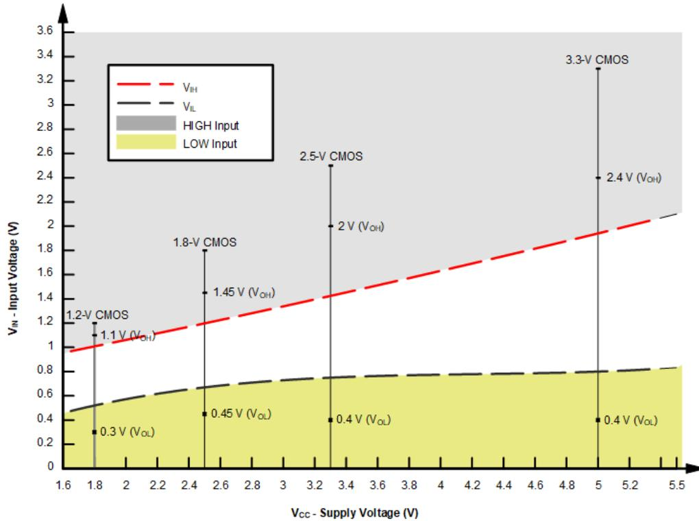
図 7-2. LVxT の入力電圧レベル
