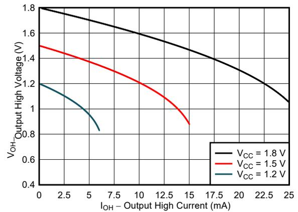
図 6-2. 標準 (T<sub>A</sub>=25°C) 出力高電圧 (V<sub>OH</sub>) とソース電流 (I<sub>OH</sub>) との関係
