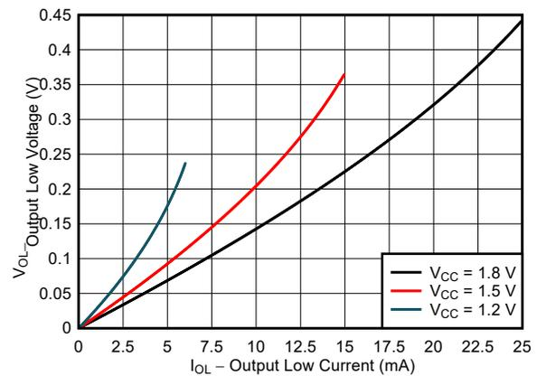
図 6-4. 標準 (T<sub>A</sub>=25°C) 出力低電圧 (V<sub>OL</sub>) とシンク電流 (I<sub>OL</sub>) との関係
