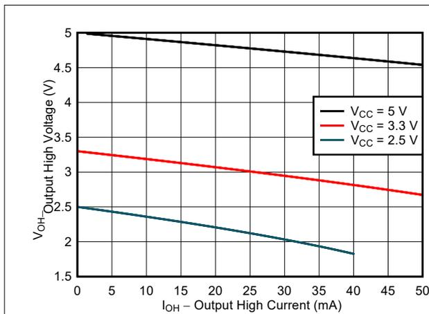
図 6-1. 標準 (T<sub>A</sub>=25°C) 出力高電圧 (V<sub>OH</sub>) とソース電流 (I<sub>OH</sub>) との関係
