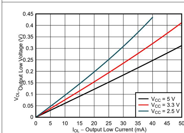
図 6-3. 標準 (T<sub>A</sub>=25°C) 出力低電圧 (V<sub>OL</sub>) とシンク電流 (I<sub>OL</sub>) との関係
