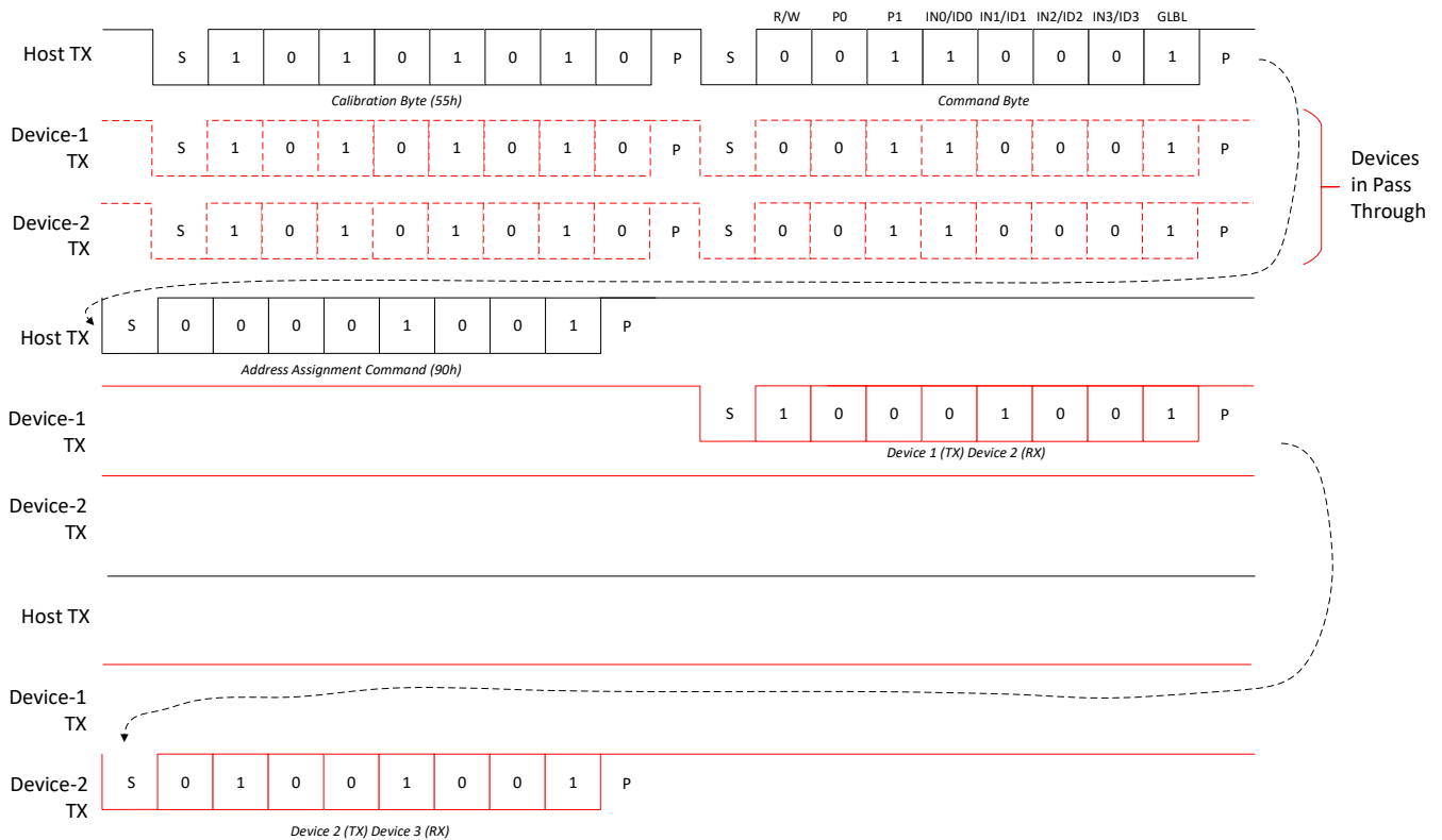
図 7-8. グローバル初期化およびアドレス割り当てのコマンド・フロー
