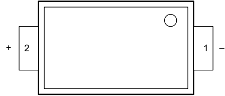
図 5-2. DYA パッケージ 2 ピン SOT-5X3 上面図
