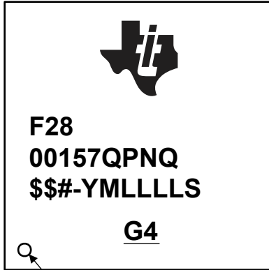
図 9-3. PN パッケージのパッケージ マーキング (AEC-Q100 グレード 1 認定)
