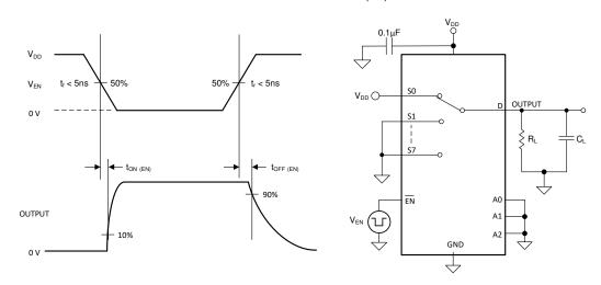
図 7-6. Turn-On and Turn-Off Time Measurement Setup
