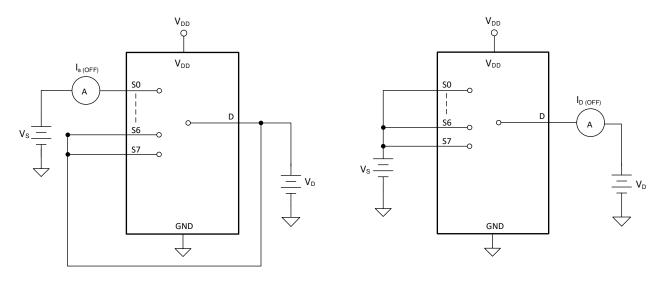
図 7-2. Off-Leakage Measurement Setup
