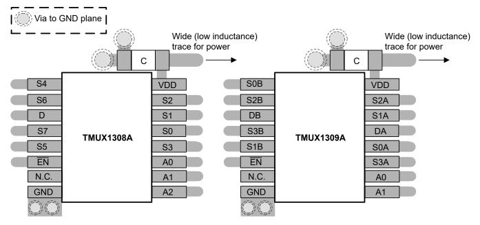
図 9-7. TMUX1308A and TMUX1309A Layout Example
