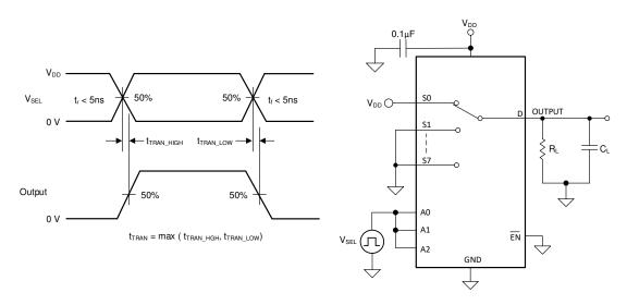
図 7-4. Transition-Time Measurement Setup
