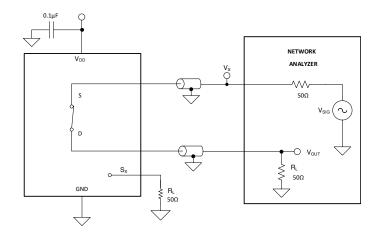
図 7-10. Bandwidth Measurement Setup
