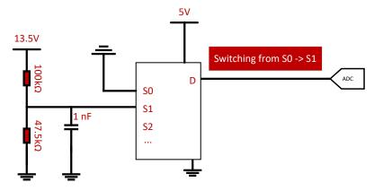
図 8-1. Test Circuit Setup
