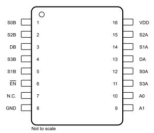
図 5-2. TMUX1309A: PW Package, 16-Pin TSSOP (Top View)
