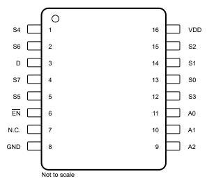
図 5-1. TMUX1308A: PW Package, 16-Pin TSSOP (Top View)
