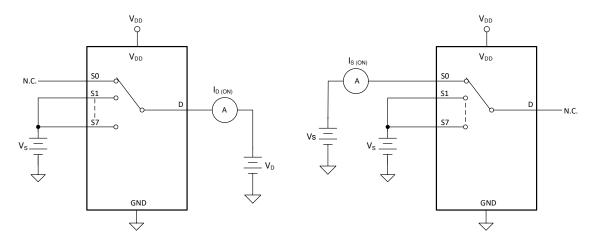
図 7-3. On-Leakage Measurement Setup
