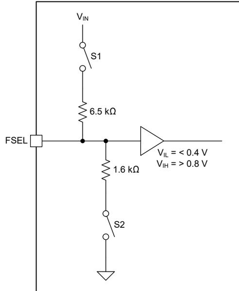
図 8-10. FSEL R2D Converter Functional Block Diagram
