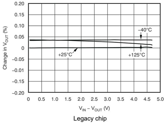
图 5-1. V<sub>IN</sub> Line Regulation
