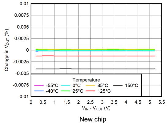
图 5-2. V<sub>IN</sub> Line Regulation
