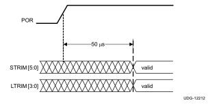
Figure 27. Power-ON OTP ROM Read Timing
