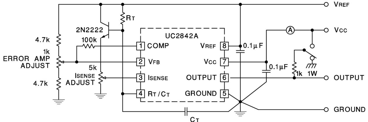
図 8-2. 開ループの実験室用テスト装置
