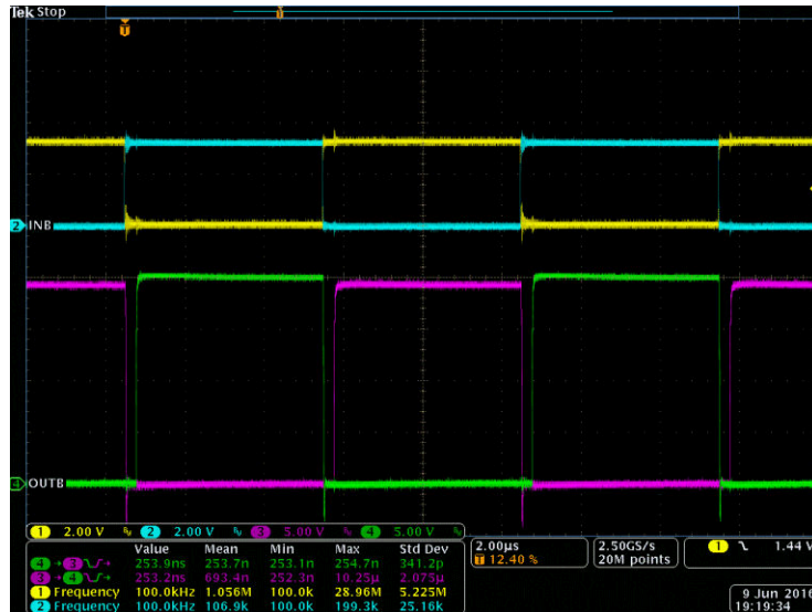
図 8-5. INA/B と OUTA/B のベンチ テスト波形
