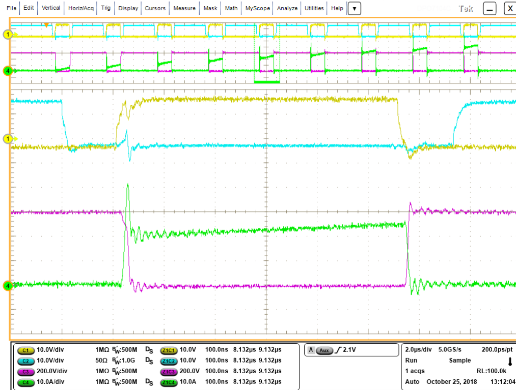
図 9-6. SiC MOSFET のスイッチング波形
