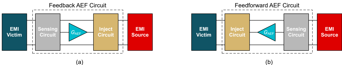
図 4-1. センシング、ゲイン、注入の各段を使用した AEF の基本的な概念。制御構造は FB (a) または FF (b) です
