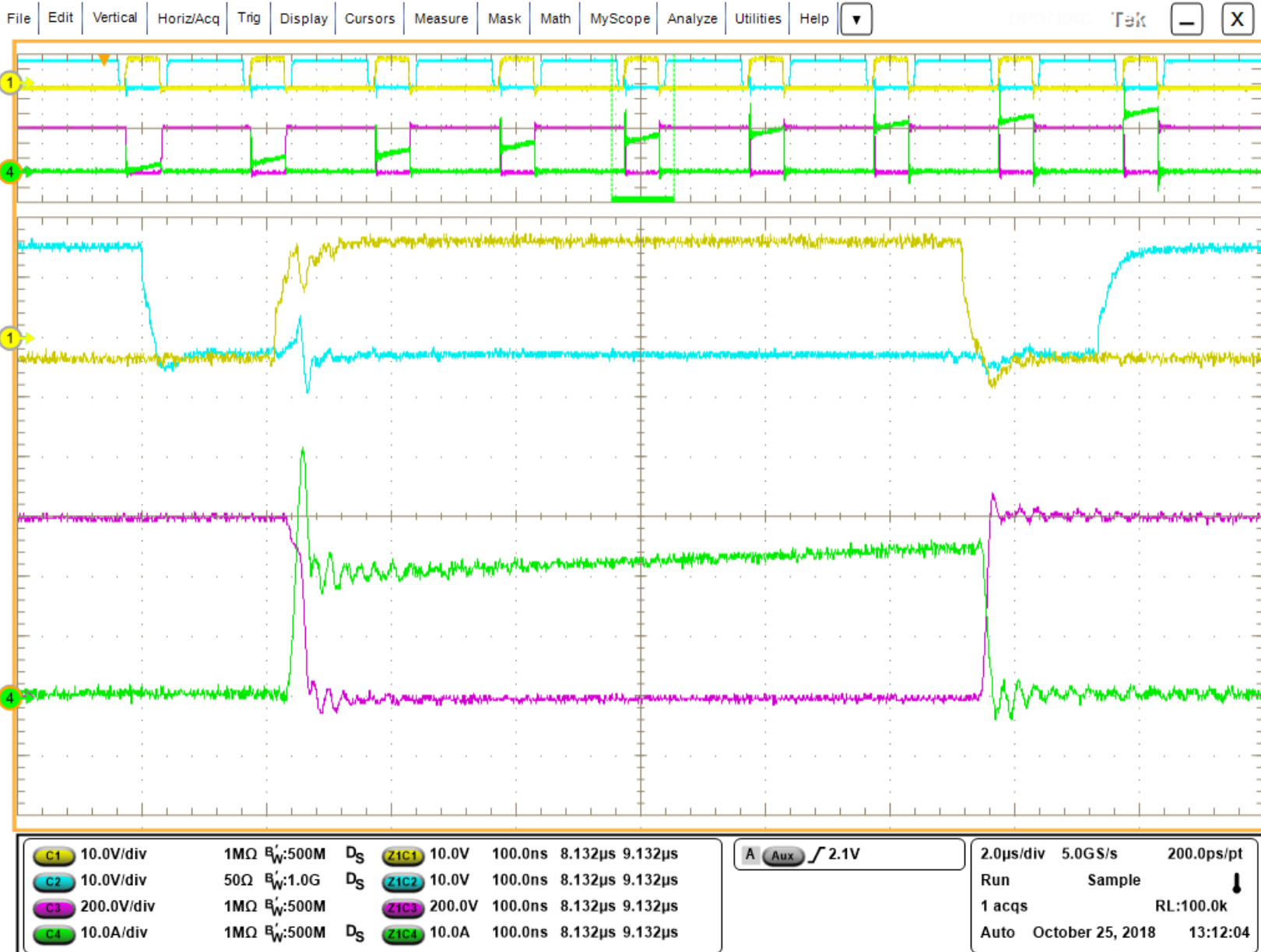
図 9-6. SiC MOSFET のスイッチング波形
