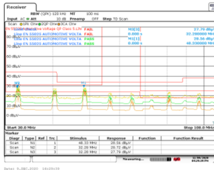
図 5. 未発売のボード (交互配置層なし) の伝導エミッションと CISPR 25 Class 5 との関係 (30~108MHz、3.8dB 不足で不合格、ワースト ケースは 32MHz での「CISPR 平均値」検出) 出典: テキサス・インスツルメンツ
