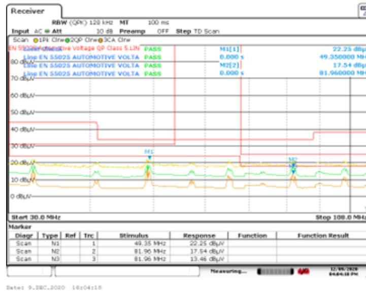
図 4. 絶縁型 5V リファレンス デザイン (交互配置された層を利用) の伝導エミッションと CISPR 25 Class 5 との関係 (30~108MHz、4.5dB の余裕を持って合格、ワースト ケースは 82MHz での「CISPR 平均値」検出) 出典: テキサス・インスツルメンツ
