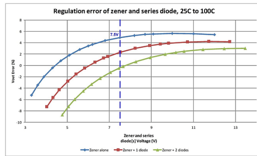
図 2. 4.7V を超えるツェナー値で直列に 1 個以上のダイオードを追加すると、電圧安定化誤差を低減できます。
