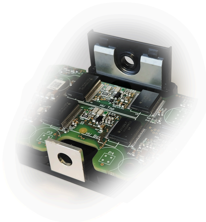
図 3. UCC5880-Q1 および UCC14141-Q1 を実装したゲートドライバプリント基板をパワー モジュールに搭載
