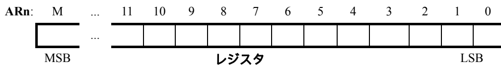
図 6-9. AR 間接アドレッシング・モードを使用したレジスタ・ビットへのアクセス
