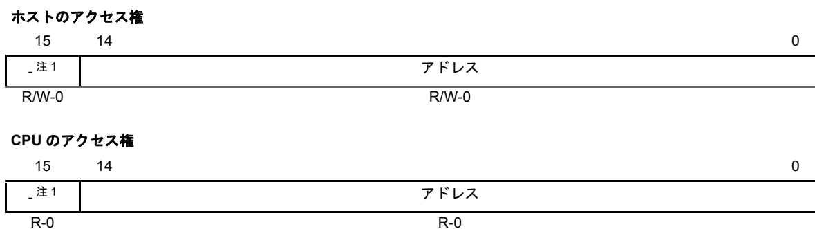
図 29. アドレス・レジスタ (HPIAR または HPIAW) のフォーマット - TMS320VC5502 デバイス
