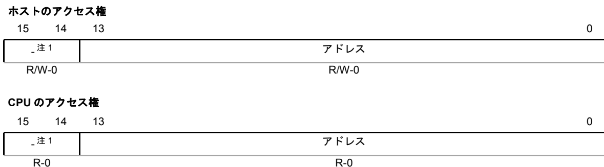
図 28. アドレス・レジスタ (HPIAR または HPIAW) のフォーマット - TMS320VC5501 デバイス
