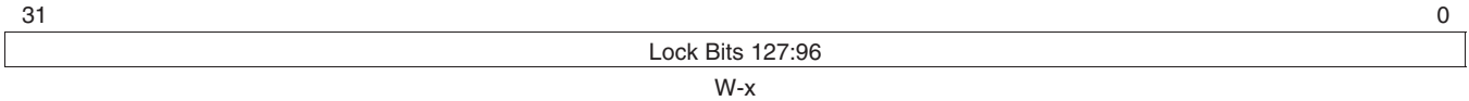
図 2-11. L1P メモリ・プロテクション・ロック・レジスタ 3 (L1PMPLK3)
