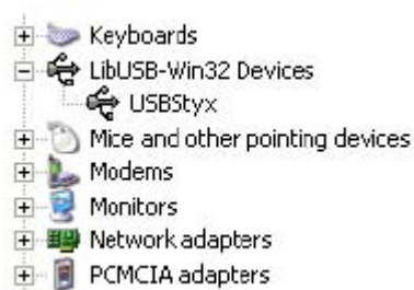
図 24 デバイスマネージャを使用してUSBStyxドライバを確認する
