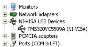
図 16 デバイスマネージャを使用したNI-VISAドライバの確認
