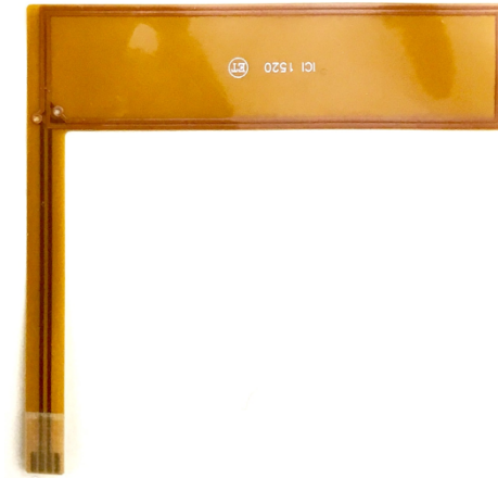
図 44. NFC Flex PCB Antenna
