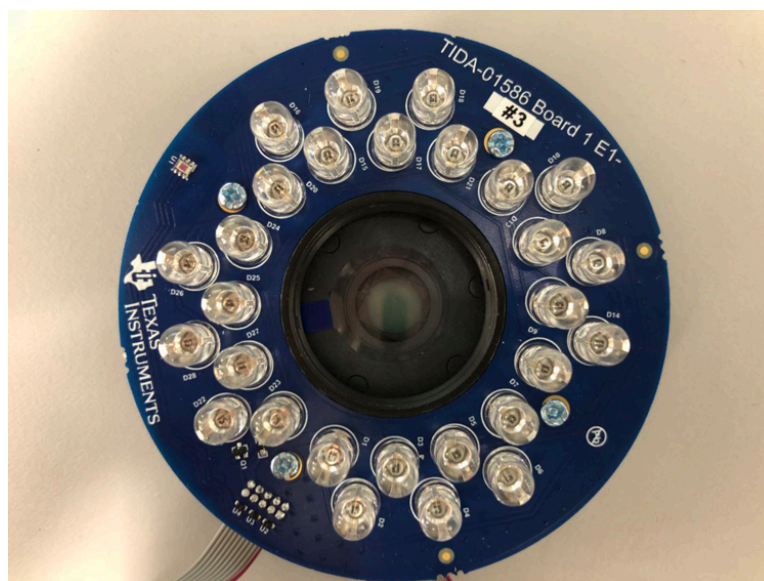
Figure 19. IR LED Array and ALS Board (Board-1)
