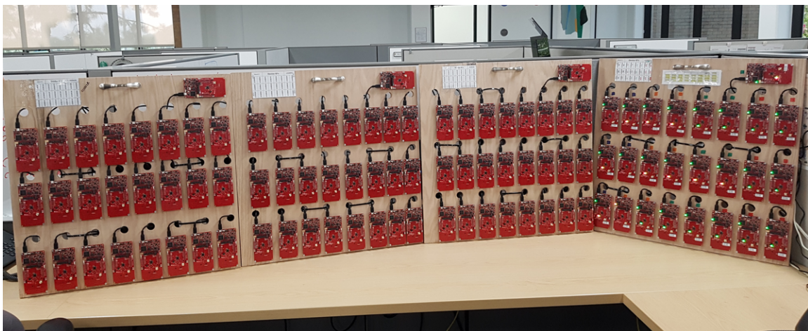
図 23. 100-Node Network Test Setup
