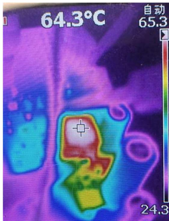
図 3-12. 降圧インダクタ L8 の温度上昇
