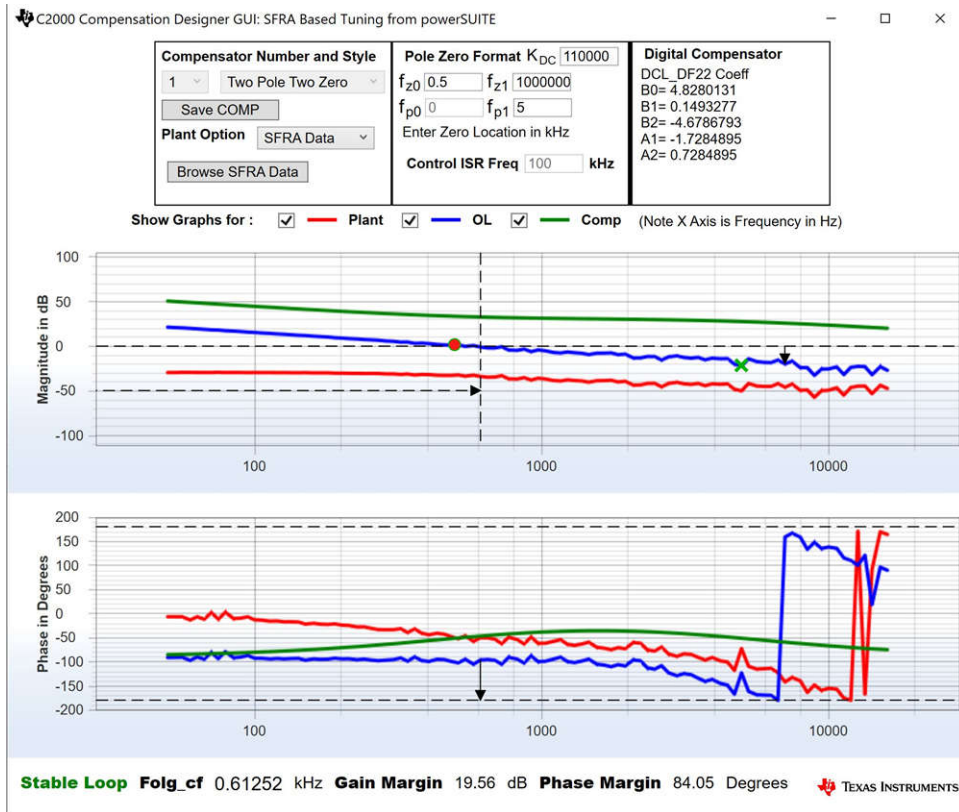
図 5-20. 電圧ループの SFRA ベースのプラント測定を用いた補償器の設計、出力に抵抗性負荷が接続されている場合 (500kHz の測定データ)
