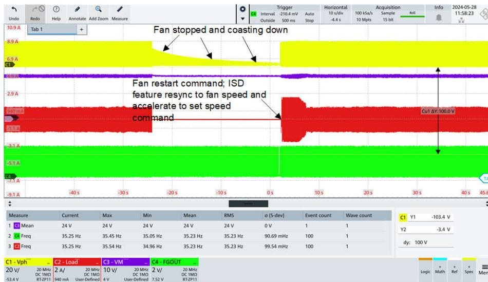
図 4-7. フォワード ウィンドミリング (低速 ISD 順方向再同期)
