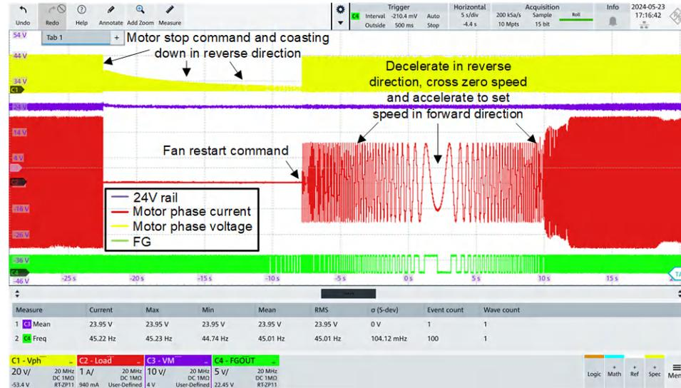
図 4-8. リバース ウィンドミリング (ISD 逆方向再同期)
