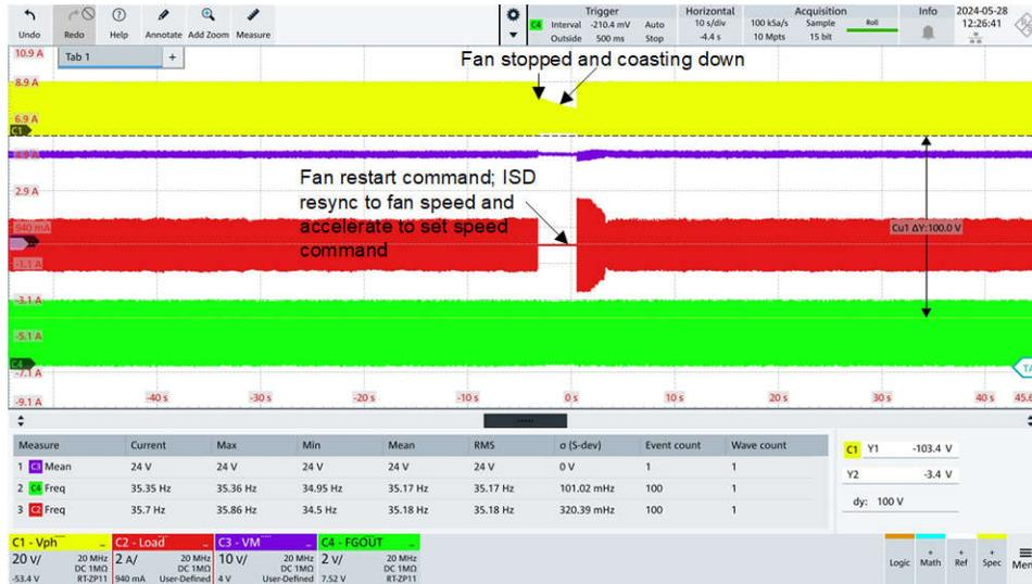
図 4-6. フォワード ウィンドミリング (高速 ISD 順方向再同期)
