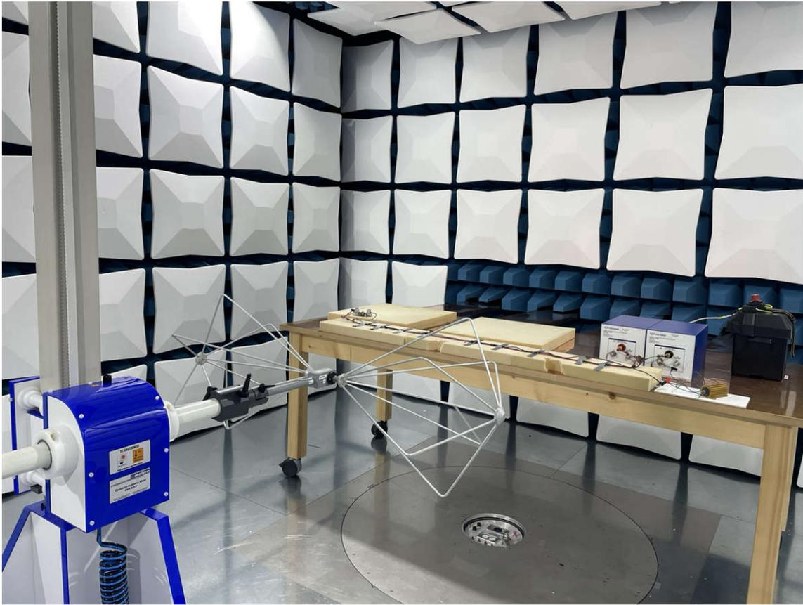
図 4-26. バイコニカル アンテナを使用した RE 構成:30MHz~200MHz
