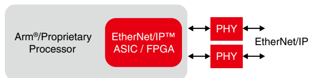
図 8. 内蔵 EtherNet/IP とプロセッサ。
