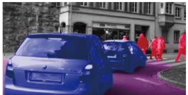
図2. TDA2 SoCでTIDLを使用したセマンティック・セグメンテーション。
