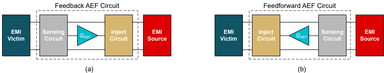
그림 4-1. 감지, 이득 및 주입 단계를 지원하는 AEF의 기본 개념. 제어 구조는 FB(a) 또는 FF(b)가 될 수 있습니다.
