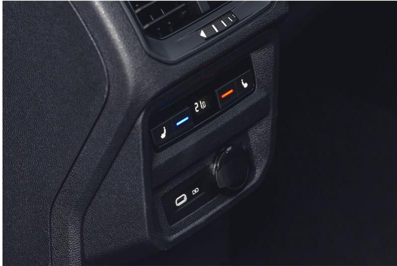
USB Type-C®는 노트북, 태블릿, 스마트폰의 새로운 고속 충전 표준으로 널리 알려져 있지만, 점점 더 다양한 전력 공급 및 연결 애플리케이션에서 사용되고 있습니다. USB Type-C의 속도와 효율성은 놀랍습니다. USB PD(USB Power Delivery) R3.1 사양의 진화로 단일 USB Type-C 커넥터는 최대 240W(48V 및 5A)의 전력을 지원할 수 있으며, 이는 USB 표준 A 커넥터의 7.5W(5V 및 1.5A)에서 크게 개선된 수치입니다.
