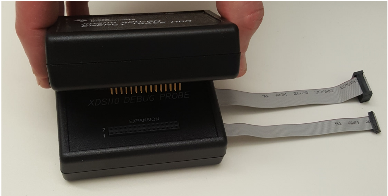
그림 4. XDS110 프로브와 ETHDR 시스템
