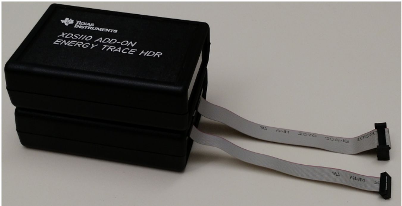
그림 4. XDS110 프로브와 ETHDR 시스템
