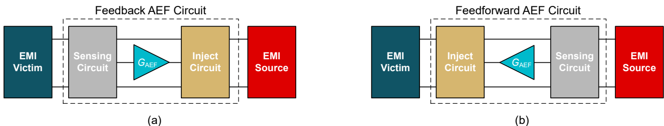
圖 4-1. 具有感測、增益和注入階段的 AEF 基本概念。控制結構可以是 FB (a) 或 FF (b)
