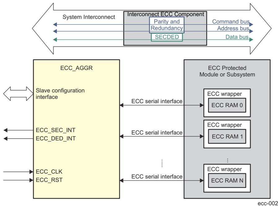
**Figure 22-9. ECC Aggregator Block Diagram**
