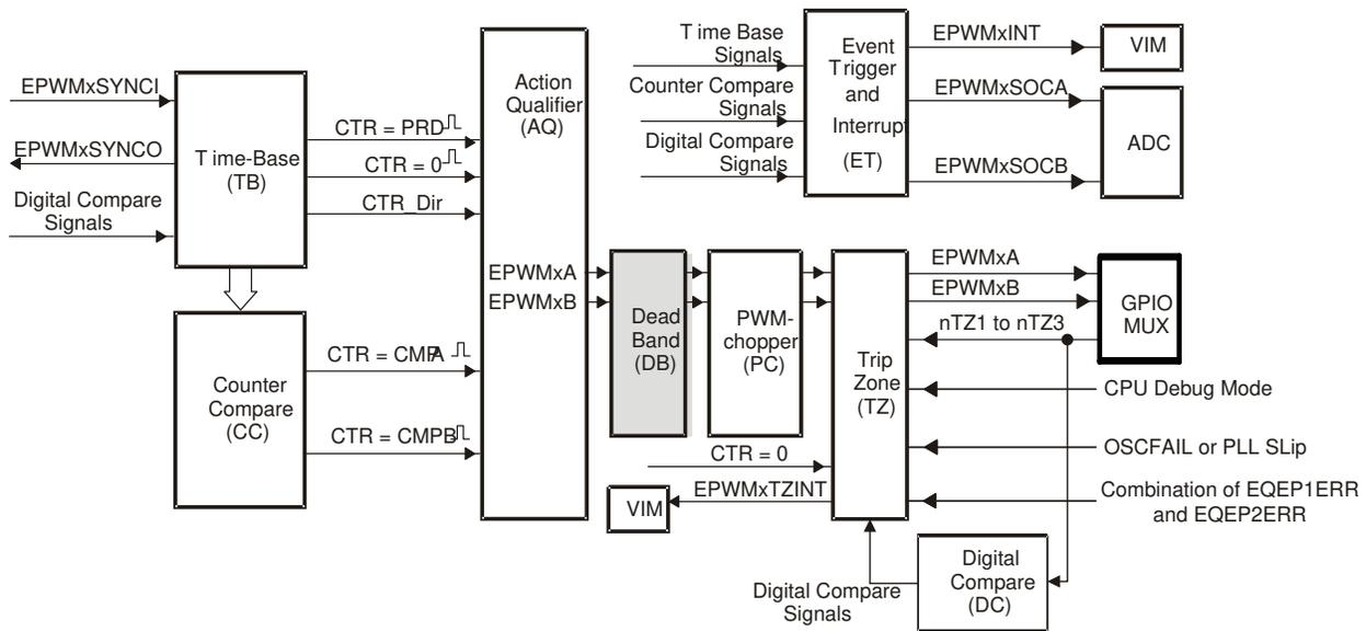
**Figure 18-27. Dead\_Band Submodule**
