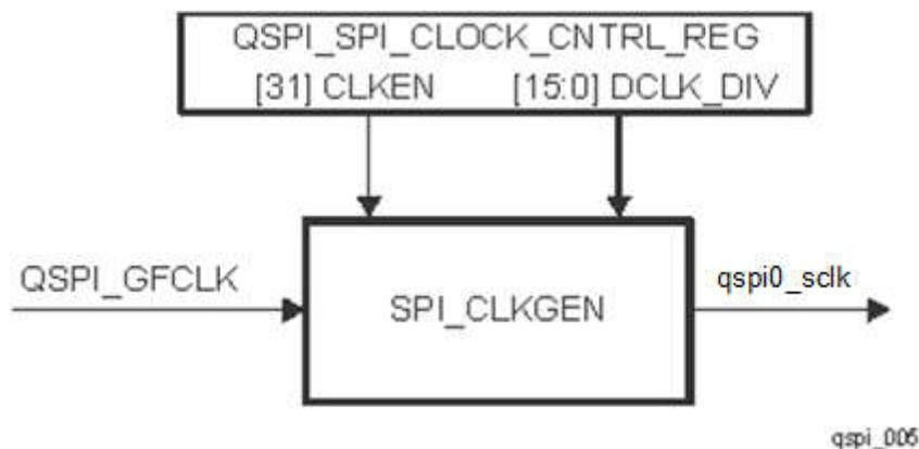
**Figure 9-4. SPI\_CLKGEN Block**
