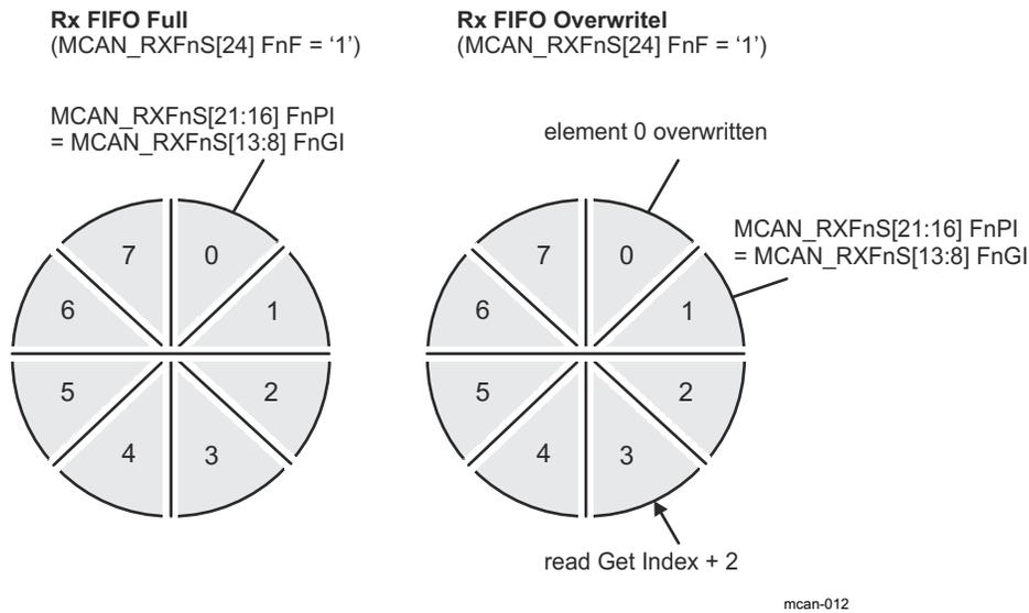
**Figure 12-11. Rx FIFO Overflow Handling**
