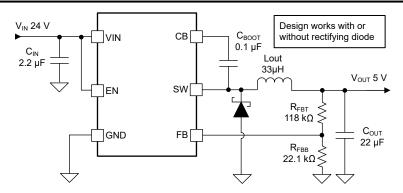
Figure 8-2. Replacing Non Sync Converter
