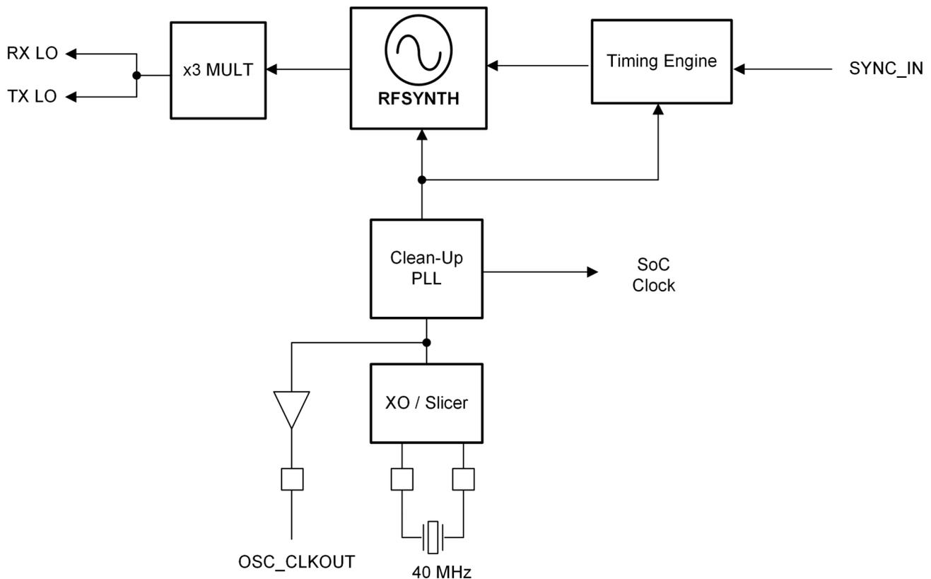
**Figure 8-2. Clock Subsystem**
