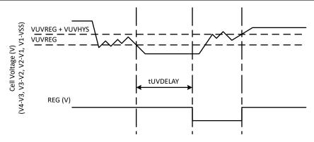
Figure 7-3. REG Output Timing
