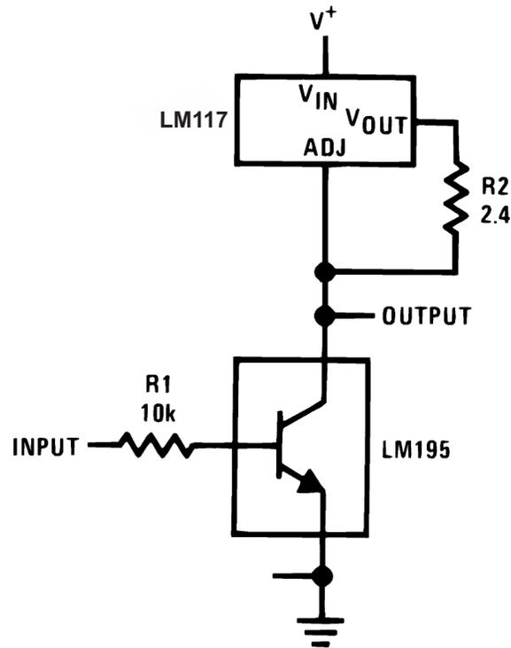
**Figure 27. Common-Emitter Amplifier**
