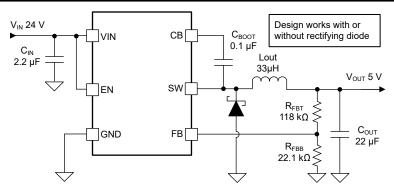
Figure 8-2. Replacing Non Sync Converter
