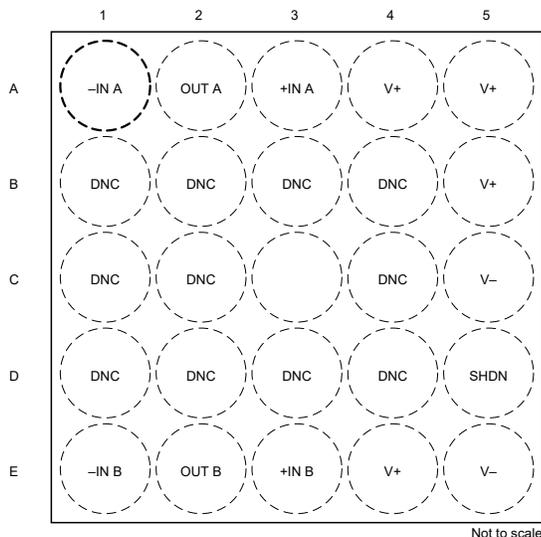
**Figure 4-5. OPA2328 YBJ Package 24-Pin DSBGA (Top View)**
