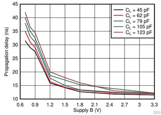
$T_A = 25^\circ\text{C}$   $V_{CCA} = 0.8\text{ V}$
