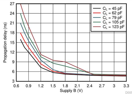
$T_A = 25^\circ\text{C}$   $V_{CCA} = 1.8\text{ V}$
