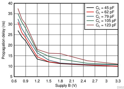
$T_A = 25^\circ\text{C}$   $V_{CCA} = 0.9\text{ V}$
