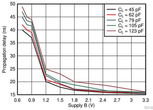
$T_A = 25^\circ\text{C}$   $V_{CCA} = 0.7\text{ V}$
