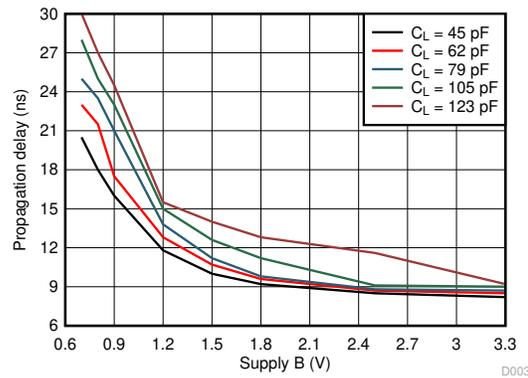
$T_A = 25^\circ\text{C}$   $V_{CCA} = 1.2\text{ V}$
