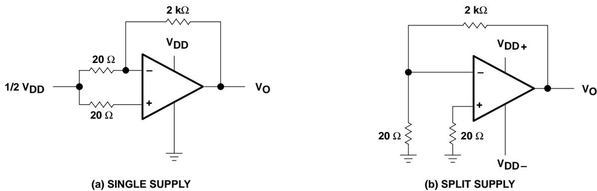
**Figure 99. Noise-Test Circuit**
