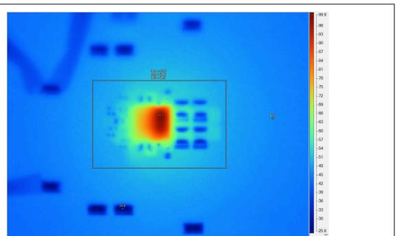
V<sub>OUT1</sub> = 5V, V<sub>OUT2</sub> = 3.3V, I<sub>OUT1</sub> = 3A, I<sub>OUT2</sub> = 3A, FSW = 1MHz
