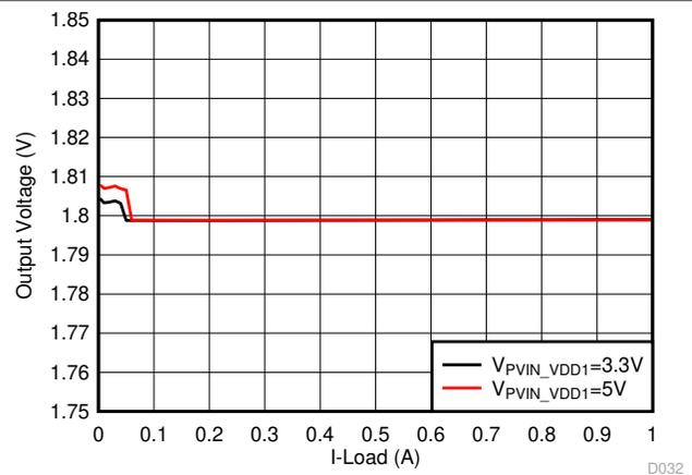
**Figure 8-6. VDD1 Load Regulation,  $V_{OUT} = 1.8\text{ V}$**
