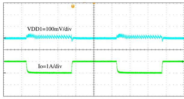
Figure 8-26. VDD1 Transient Response, 0 A to 1 A
