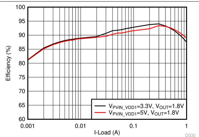
**Figure 8-4. VDD1 Efficiency Curve,  $V_{OUT} = 1.8\text{ V}$**
