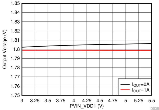
**Figure 8-9. VDD1 Line Regulation,  $V_{OUT} = 1.8\text{ V}$**
