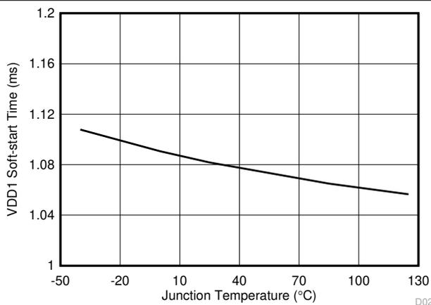
**Figure 6-23. VDD1 Soft-Start Time vs Junction Temperature**
