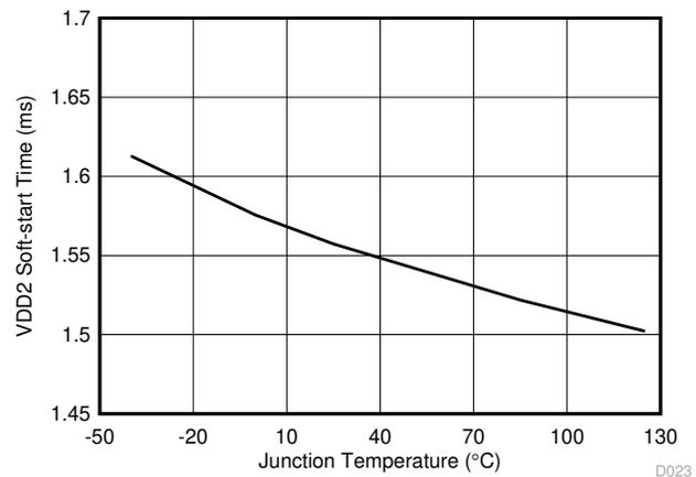
**Figure 6-22. VDD2 Soft-Start Time vs Junction Temperature**
