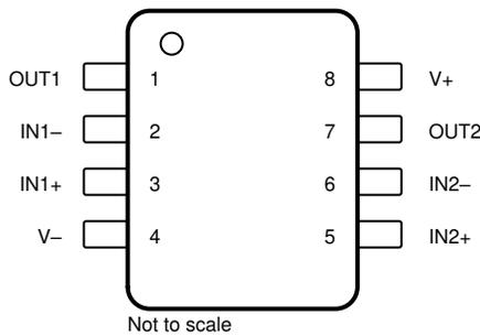
**Figure 6-6. TLV9002 D, DGK, PW, DDF Package
