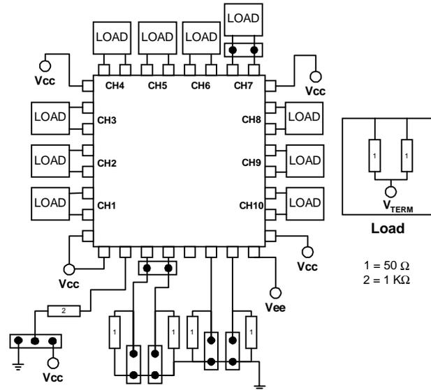
**Figure 3. 1:10 LVPECL Test Setup**
